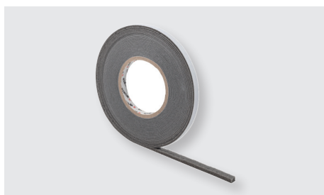
VKP® Plus taśma uszczelniająca Wysokiej jakości, wodoodporna, wstępnie sprasowana taśma uszczelniająca BG1 do bezpiecznego i trwałego uszczelniania połączeń do ponad 600 Pa Baza chemiczna: Drobna pianka poliuretanowa o otwartej strukturze komórkowej Zrównoważony rozwój: niska emisja Art. no. 0875 0...
